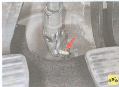
5. Под панелью приборов отверните гайку и извлеките болт клеммового соединения рулевого вала и вала рулевого механизма.
