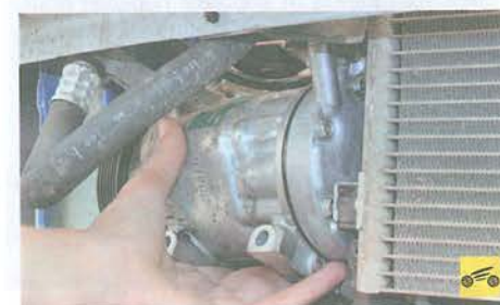
32. ...и, не отсоединяя от него трубопроводы, отведите в сторону и закрепите любым доступным способом (например, привязав проволокой).
