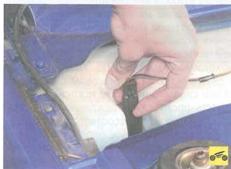
3. Отсоедините колодку жгута проводов от электронасоса омывателя.
