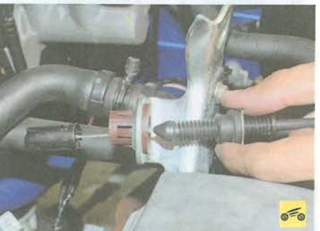
26. ...извлеките трос из отверстия кронштейна и отведите в сторону.
