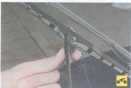
2. Нажмите на фиксатор...
