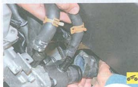
26. Отсоедините шланги от патрубков термостата, головки блока цилиндров и водораспределительной трубы.
