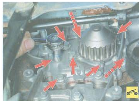
3. Выверните восемь болтов крепления водяного насоса к блоку цилиндров.
