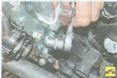
33. Выверните болт крепления «массового» провода...
