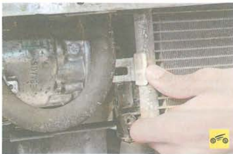
13. Разъедините радиаторы системы охлаждения двигателя и системы кондиционирования, для чего приподнимите радиатор системы кондиционирования, выведите его проушины из держателей радиатора системы охлаждения и опустите.
