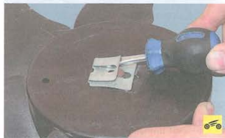
3. Подденьте отверткой, сдвиньте вперед...
