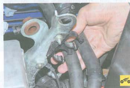
27. Извлеките шланги отопителя из держателей на кронштейне и отведите их в сторону.
