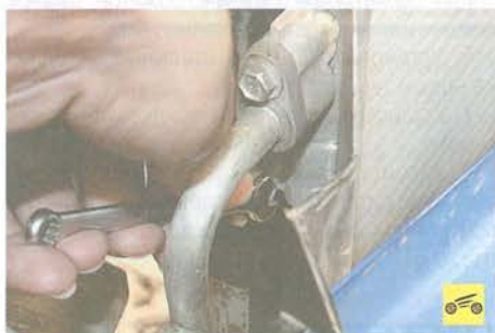
9. ...и правый болты крепления радиатора системы кондиционирования к радиатору системы охлаждения двигателя.
