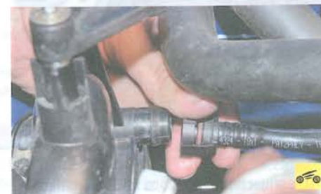
23. Отсоедините от впускной трубы шланг продувки адсорбера...
