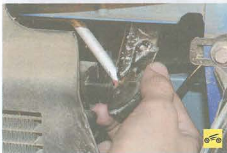
11. ...и снимите левый кронштейн крепления радиатора системы охлаждения.
