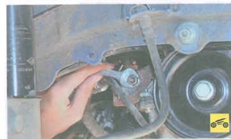
30. Выверните болт крепления к двигателю держателя трубопровода системы гидроусилителя рулевого управления.
