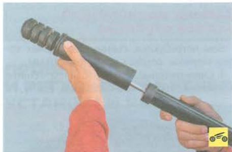
11. Снимите со штока амортизатора буфер сжатия в сборе с защитным чехлом.
