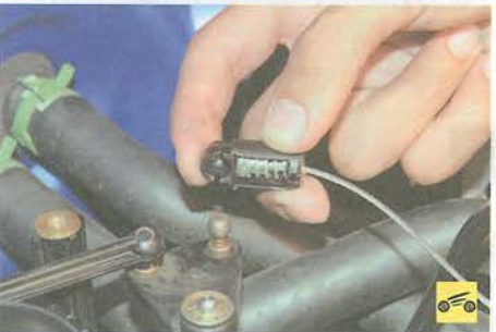
25. Снимите с шарового пальца промежуточного рычага наконечник троса привода дроссельной заслонки...
