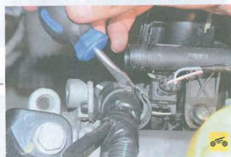
21. Выведите моторный жгут из держателей на двигателе (см. «Замена прокладки головки блока цилиндров», с. 76) и отведите его в сторону.
