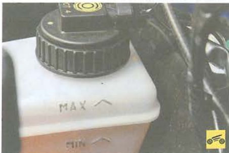
3. Проверьте уровень тормозной...
