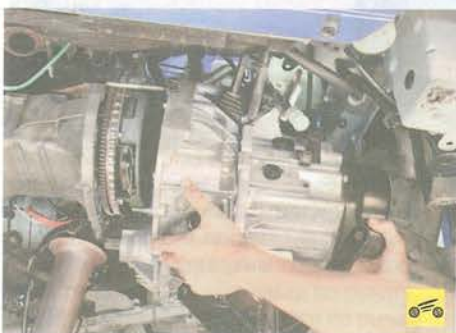
36. ...и коробку передач надежные опоры.
