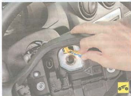
6. Выньте через отверстие провод с колодкой подушки безопасности и снимите рулевое колесо.
