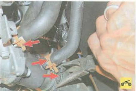
30. Ослабьте хомуты крепления трех шлангов, сжав пассатижами их отогнутые усики, сдвиньте хомуты по шлангам...
