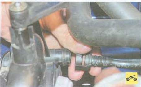
29. Отсоедините от впускной трубы шланг к вакуумному усилителю тормозов, сжав фиксаторы его крепления.
