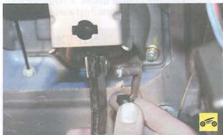
Рис. 9.7. Регулировочные размеры вакуумного усилителя тормозов: X=22,3 мм; L=145,8 мм
