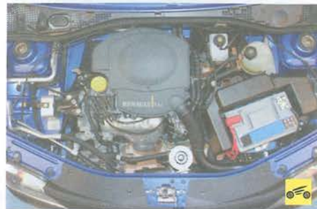
5. Внимательно осмотрите двигатель и подкапотное пространство. Обратите внимание на потеки бензина, масла, тормозной и охлаждающей жидкостей. Убедитесь в це-
