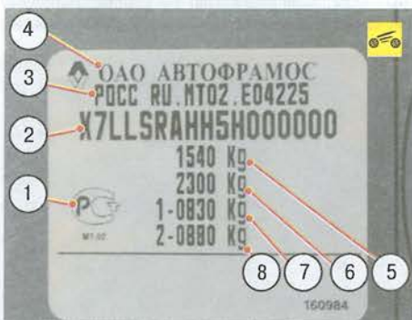
Рис. 1.5. Идентификационная наклейка: 1 – знак соответствия сертификации; 2 – идентификационный номер автомобиля; 3 – код органа, выдавшего сертификат, и номер одобрения транспортного средства; 4 – завод-изготовитель; 5 – максимальная разрешенная масса автомобиля; 6 – максимальная разрешенная масса автомобиля с прицепом; 7 – допустимая нагрузка на переднюю ось автомобиля; 8 – допустимая нагрузка на заднюю ось автомобиля
