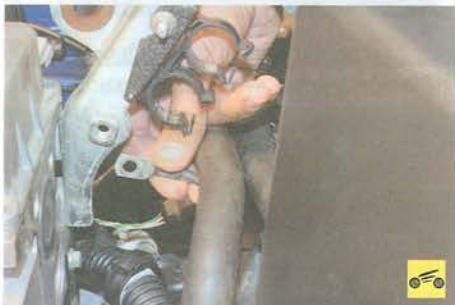
34. ...и отсоедините провод.
