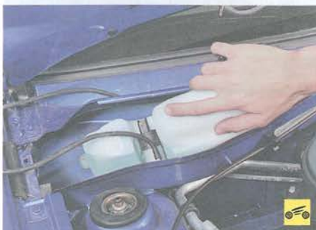
6. ...извлеките его из короба воздухопритока и отсоедините шланг от насоса.
