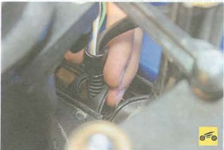
23. Извлеките жгут из среднего верхнего держателя на впускной трубе...
