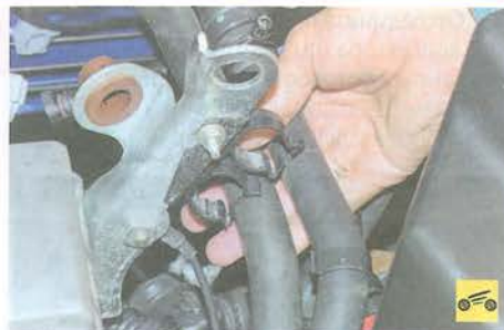
32. Извлеките шланги отопителя из держателей на кронштейне.
