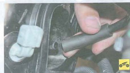
23. Отсоедините от впускной трубы шланг продувки адсорбера...
