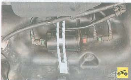
– засоренный топливный фильтр;
