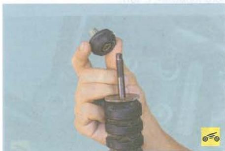
8. Снимите со штока амортизатора нижнюю резиновую подушку в сборе с распорной втулкой.
