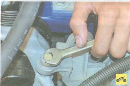
35. Выверните болт крепления кронштейна насоса гидроусилителя рулевого управления к головке блока.
