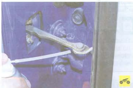
3. ...и палец ограничителя (моторное масло или смазка типа NGLI №1 или NGLI №2).
