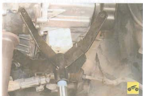
36. ...и коробку передач надежные опоры.
